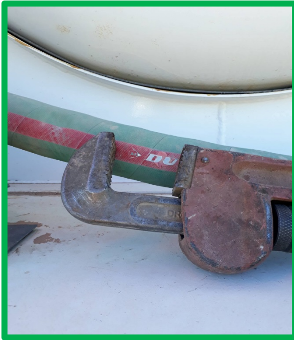
4. Llave Stilson en buenas condiciones. Limpiar dientes
