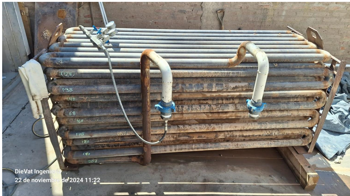
Figura 5. Serpentín H-24-HC01 – Intercambiador de calor.
